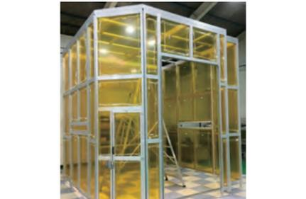
液晶ライン向けロボットフェンス
